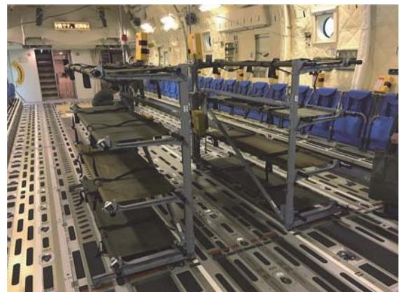
図3 傷病者搭載ユニットの配置と担架配置
